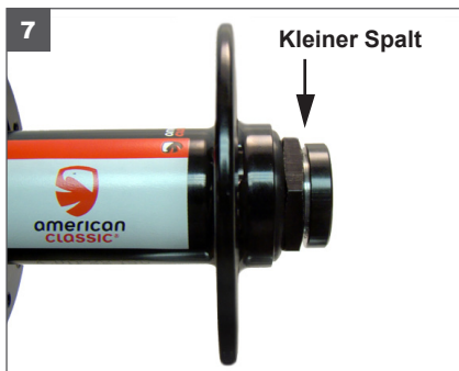
7. Schrauben Sie die Endkappe komplett auf die Achse. HINWEIS: Die Endkappe wird NICHT bündig mit der Einstellmutter abschließen. Es bleibt ein kleiner Spalt. In der Einstell-Mutter ist ein Dichtungsring und sie muss daher nicht gekontert werden.
