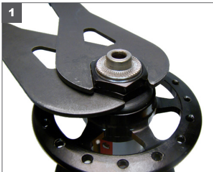
1. Benutzen Sie die zwei 19mm Konus-Schlüssel, um durch drehen, gegen den Uhrzeigersinn, die Muttern zu lösen.
