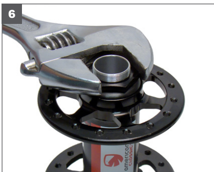
6. Schrauben Sie die 22mm Einstell-Mutter mit der Staubkappe installiert auf die 15mm Steckachse und ziehen Sie sie mit einem Schraubenschlüssel fest. Ziehen Sie die Einstellmutter fest bis kein Spiel mehr besteht und drehen Sie dann eine viertel Umdrehung zurück.
